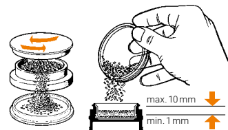
Fill Filling Chamber
